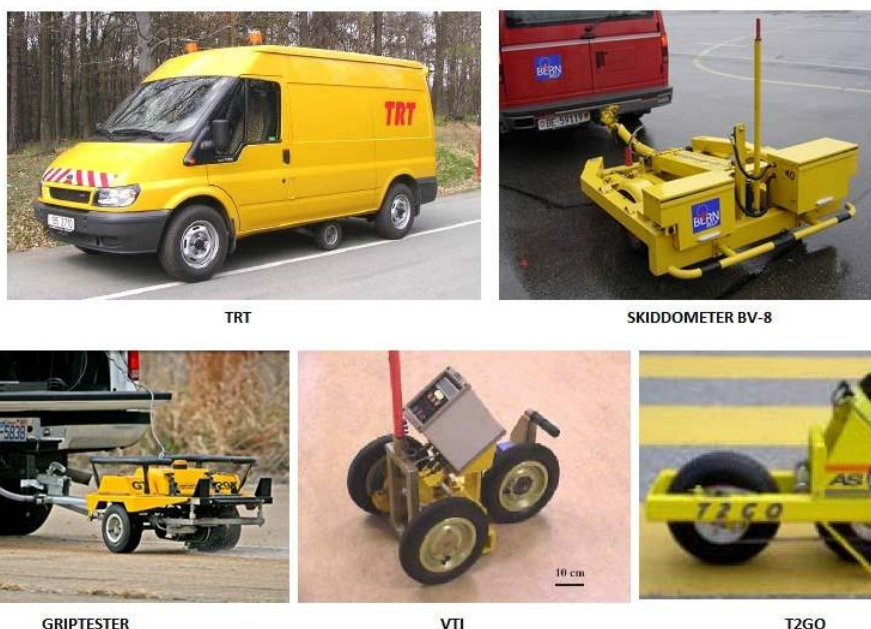
Figura 815 - 1. Equipos de medida con rueda parcialmente bloqueada con grado de deslizamiento fijo
